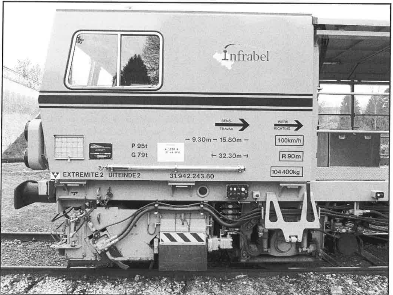
Vue latérale de l'extrémité n°2 du modèle réel comportant, outre la plateforme, les plaques "constructeur" et "agrément". Type : 09-3X; châssis : n°3389. Le modèle réel comporte un anachronisme : la plaque d'agrément indique un n° de parc SNCB 31.942.243.63 alors que la numérotation de l'engin est 31.942.243.60... aller comprendre. Ci-dessous à gauche : la face droite juste avant le raccord entre éléments. Ci-dessous à droite : la face gauche, juste à la fin de l'escalier à l'extrémité 1. En bas : le modèle reproduite en HO par Viesmann avec l'enlèvement de la partie à déplacer vers un élément à construire soi-même...
