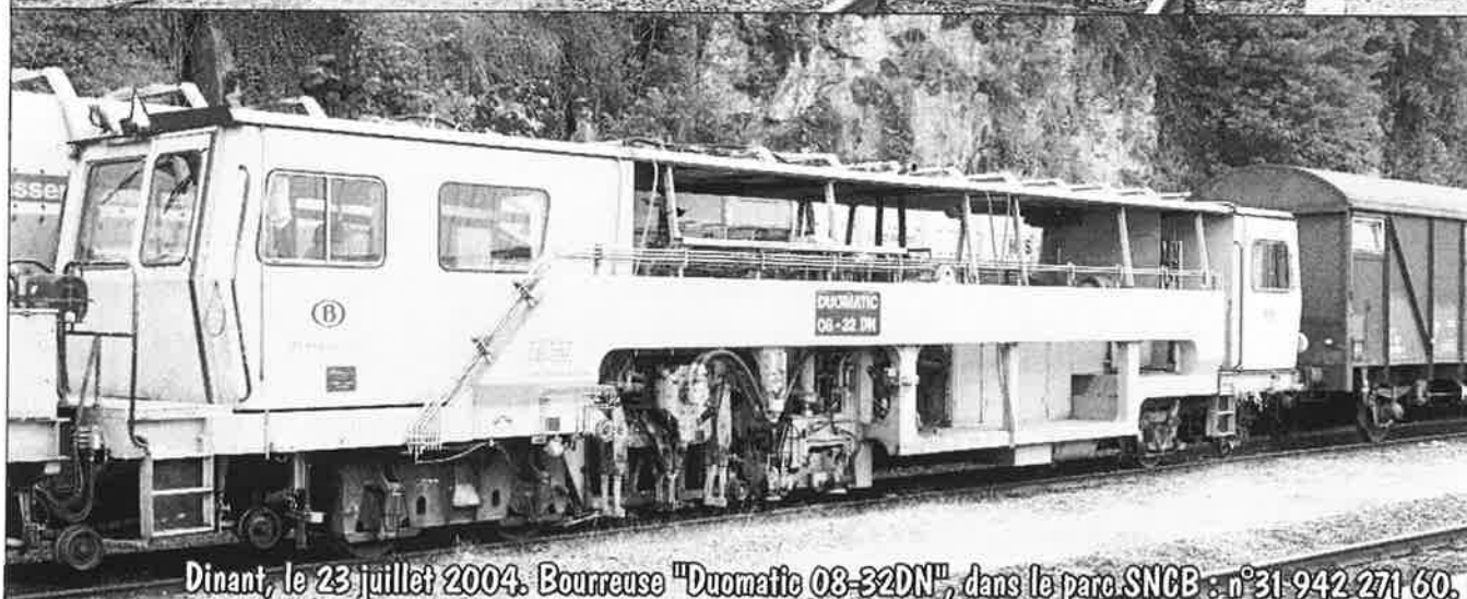
En gare de Dinant, le 23 juillet 2004, train de travaux. A l'avant plan, une niveleuse de ballast.
