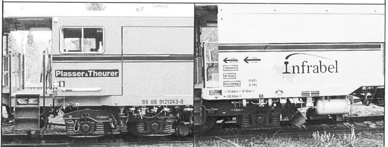
Vue latérale de l'extrémité n°2 du modèle réel comportant, outre la plateforme, les plaques "constructeur" et "agrément". Type : 09-3X; châssis : n°3389. Le modèle réel comporte un anachronisme : la plaque d'agrément indique un n° de parc SNCB 31.942.243.63 alors que la numérotation de l'engin est 31.942.243.60... aller comprendre. Ci-dessous à gauche : la face droite juste avant le raccord entre éléments. Ci-dessous à droite : la face gauche, juste à la fin de l'escalier à l'extrémité 1. En bas : le modèle reproduite en HO par Viesmann avec l'enlèvement de la partie à déplacer vers un élément à construire soi-même...
